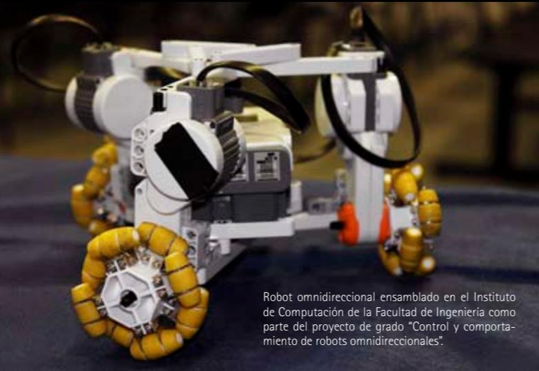
Robot omnidireccional ensamblado en el Instituto de Computación de la Facultad de Ingeniería como parte del proyecto de grado "Control y comportamiento de robots omnidireccionales".
