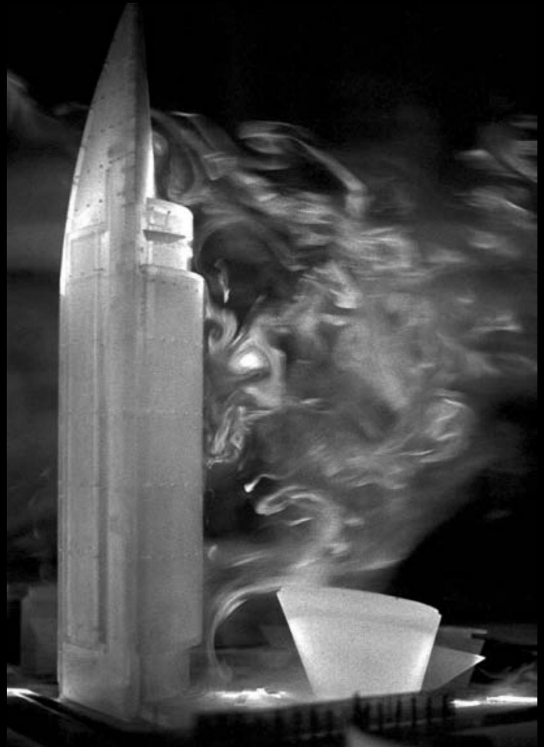
Estudio aerodinámico y aeroelástico de la Torre de las Comunicaciones (maqueta).
