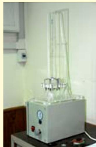
El modulómetro, un dispositivo que mide el módulo de elasticidad de las válvulas cardíacas, desarrollado por los expertos del Laboratorio de Biomecánica.
