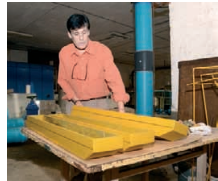
El Ing. Jorge Freiría prepara los modelos de barcasas que se utilizan para realizar ensayos que determinan la resistencia al avance en el agua de la embarcación.
